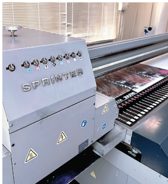
Планшетный УФ-принтер SPRINTER TC-CF2513 , 6 печатающих головок Ricoh GEN5, 2CMYK + 2White, рабочее поле — 2,5×1,3 м
