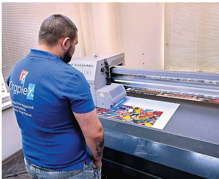
Планшетный УФ-принтер SPRINTER TC-CF2513 , 6 печатающих головок Ricoh GEN5, 2CMYK + 2White, рабочее поле — 2,5×1,3 м
