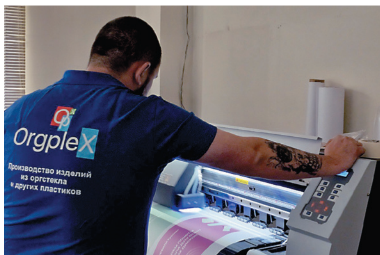
Рулонный УФ-принтер ARK-JET UV 1802. Макс. ширина печати — 1800 мм, производительность — до 24 м²/ч
