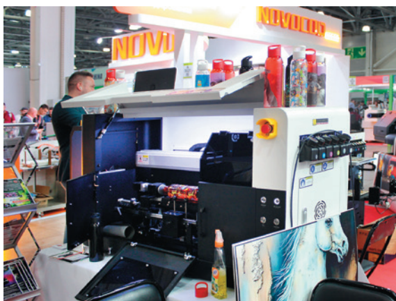
Специализированный УФ-принтер G!Digital URP-3015 для печати на цилиндрических предметах
