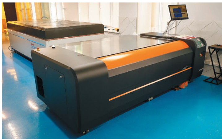
Сердце линии по выводу флексоформ: CTP Amsky Vulcan с экспонирующей машиной KMF UVA-LED
