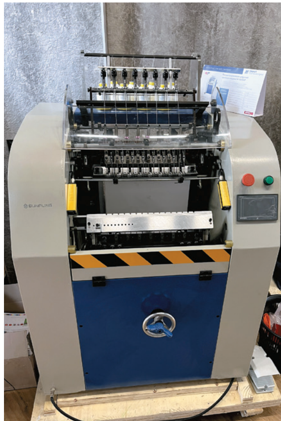
Полуавтоматическая ниткошвейная машина SF-34000P ориентирована в первую очередь на цифровые типографии. Поставщик отмечает массивную станину, обеспечивающую стабильность настроек и надёжную работу
