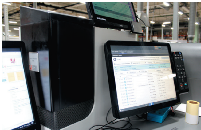
Восстановленная ЦПМ Ricoh Pro C9210 оснащена контроллером Fiery E-86. В распоряжении оператора — целых три монитора
