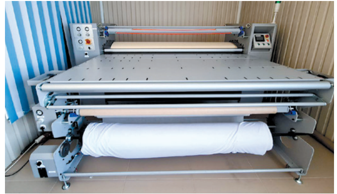
В паре с сублимационным принтером трудится каландровый термопресс TitanJet RTX34-1800A
