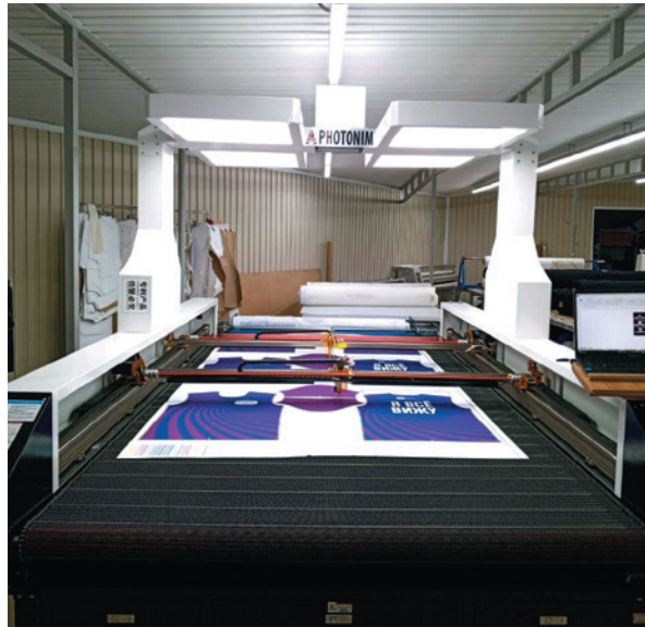
Лазерный раскройный комплекс Photonim P1827 Scan Pro заметно ускорил раскрой
