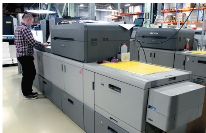
На фото — три ЦПМ Ricoh моделей Pro C9200 и Ricoh Pro C9210. В NetPrint они трудятся на изготовлении как фотопродукции, так и обычных книг, как правило — их обложек
