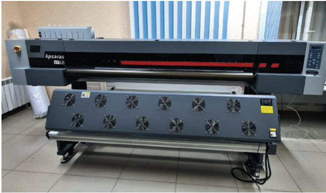
Сердце нового комплекса — сублимационный принтер GongZheng Apsaras G4-H
