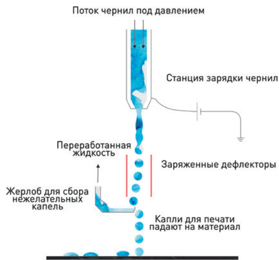
Схема CIJ-головки
