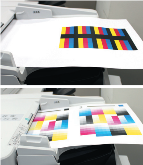
Регулировку автоградиаций быстро и удобно можно делать с помощью автоподатчика сканера. После сканирования трёх отпечатанных тестовых мишеней ЦПМ сама производит калибровку цвета
