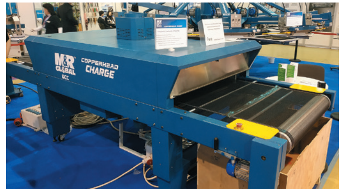
Туннельное сушильное устройство Copperhead Charge 36/6. В сегменте оборудования для цифровой печати на стенде был представлен новый цифровой сублимационный принтер DCC Sublimation Printer 72" с восемью печатными головами Epson i3200-A1, позволяющий печатать на материалах шириной до 190 см с производительностью до 335 м²/час
