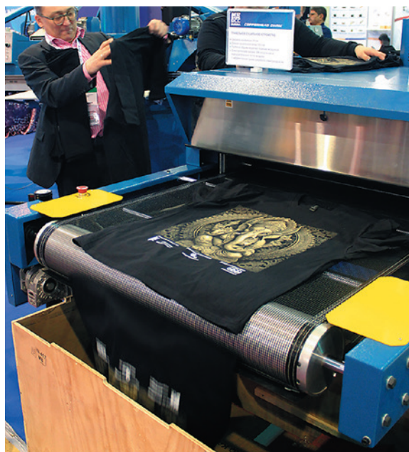
Туннельная сушка Copperhead Charge 36/6 с шириной конвейера 91 см и длиной сушильной зоны 183 см
