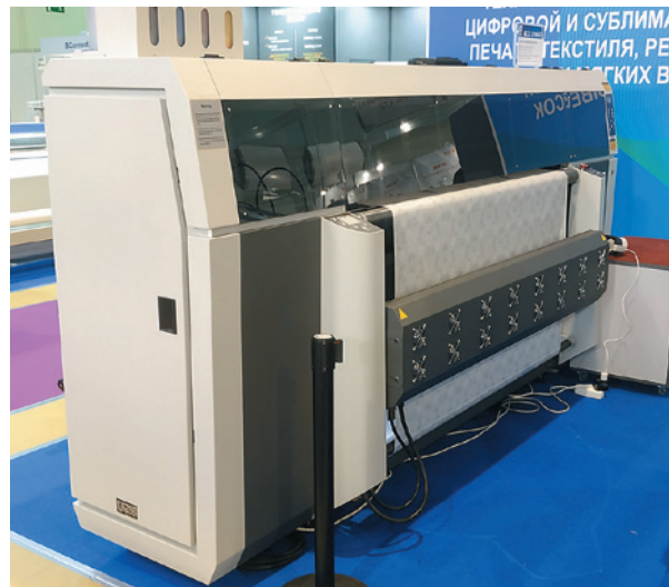
Модель первого сублимационного принтера собственной разработки DCC шириной 72"
