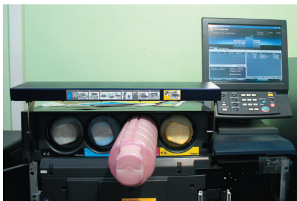
Важная составляющая высокого качества изображения, а также стабильности работы Konica Minolta AccurioPress C6100 — тонер Simitri HD E, разработанный Konica Minolta. Среди присущих ему качеств производитель заявляет низкую температуру закрепления, хорошую текучесть, высокую устойчивость к физическим воздействиям
