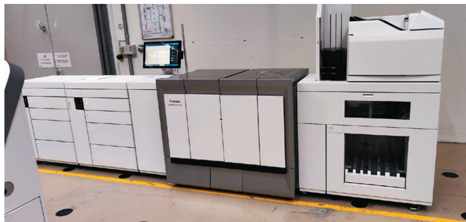
В конфигурации Canon varioPRINT 6000 TPxP для биллинга используется тонер с восковым слоем
