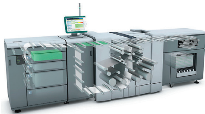
Обходной тракт для подачи страниц из любого лотка позволяет делать цветные вкладки в издания
