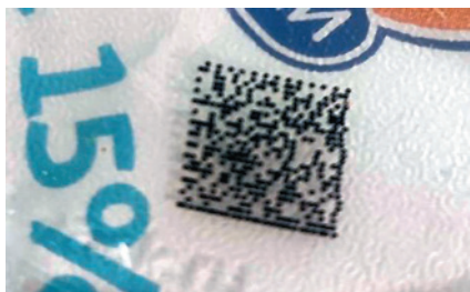
Изображение 2. Каплетруйная печать на линии производителя, наносимая на прозрачную крышку упаковки сметаны
