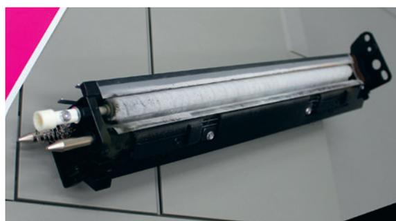
Узел автоматической смазки для первого переноса тонера теперь служит дольше: на предыдущей модели брусок под валиком со щетиной скатывался неравномерно
