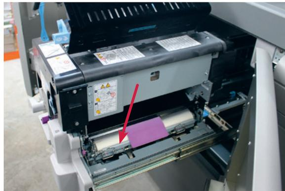
На фото показано стрелкой полотно для очистки фьюзера. На данной модели его хорошо видно оператору, поэтому заказать новое можно заранее
