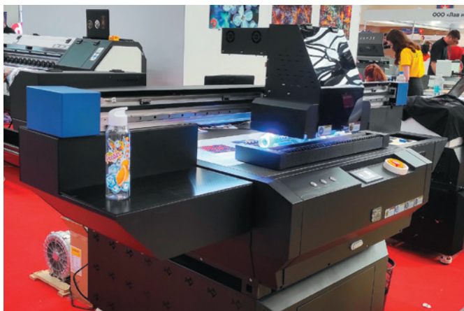
Планшетный УФ-принтер G!Digital FB-0906D Plus с опцией печати на цилиндрических предметах
