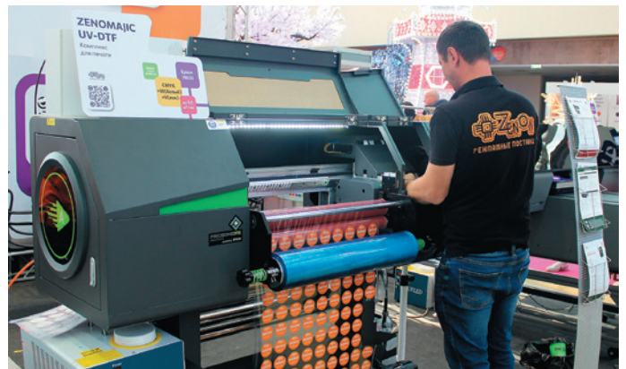
Комплекс ZenoMagic UV-DTF (ширина печати 600 мм, 3 печатающие головки Epson i1600) на стенде «ЗЕНОН-РЕКЛАМНЫЕ ПОСТАВКИ»
