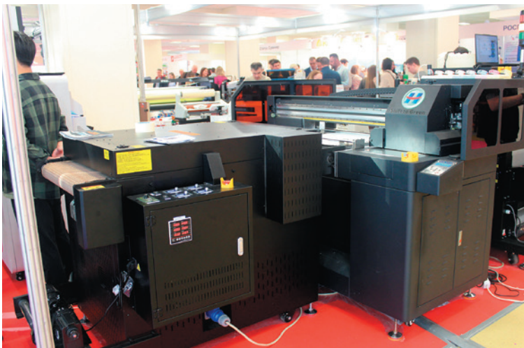
Интересная модель на стенде «ТехноПринт» — латексный принтер HongJet HJ-804L , но не рулонный, как большинство имеющихся на рынке моделей с латексными чернилами, а гибридный
