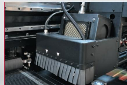
Светодиодные УФ-сушки с воздушным охлаждением для печати на термочувствительных материалах (самоклеющихся и различных ПВХ-плёнках)
