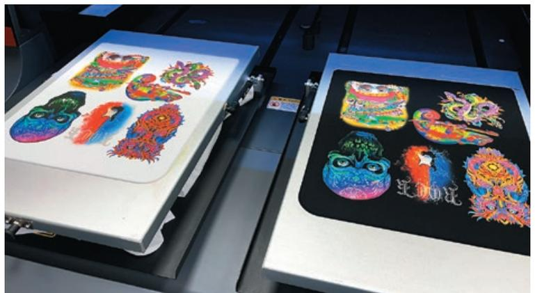
Colors GR-X7 снабжён двумя независимыми рабочими столами с рамками с гидравлическим подъёмом
