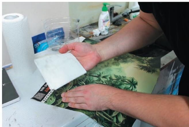
Латексные чернила отличаются эластичностью и стойкостью красочного слоя к внешним воздействиям. На фото: сервис-инженер «Смарт-Т» в демозале демонстрирует, что фотообои, запечатанные такими чернилами, можно без опаски протирать, в том числе с водой, — чернила не переходят на тряпку
