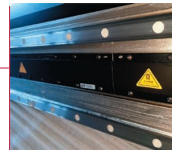
Магнитно-левитационный привод каретки снижает колебания и вибрации, а двойные направляющие обеспечивают её плавное перемещение. Каретка перемещается вдоль длинной стороны рабочего стола для увеличения производительности до 55 м²/ч
