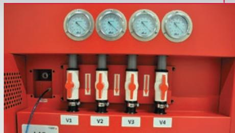
Рабочий стол снабжён четырёхзонной системой вакуумного прижима
