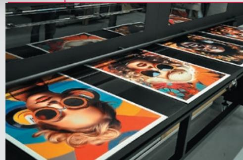
Возможна одновременная печать на нескольких листах (вплоть до четырёх), а также допускается непрерывная загрузка листов в процессе печати для достижения максимальной производительности. При нанесении изображений без полей можно сэкономить на послепечатной обработке
