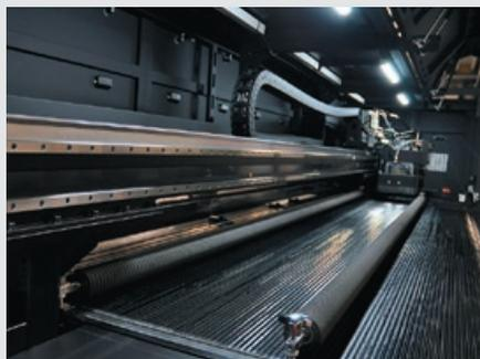
Усиленная направляющая для плавного движения каретки
