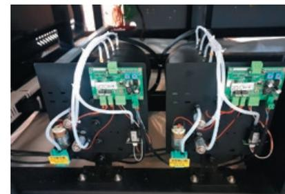
В базовую комплектацию входит система автоматической очистки печатающих головок. Для белых и цветных каналов предусмотрена отдельная система регулировки давления
