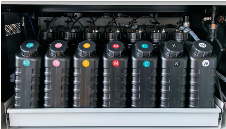
Автоматическая система подачи УФ-чернил обеспечивает непрерывную печать и оснащена датчиком низкого уровня чернил
