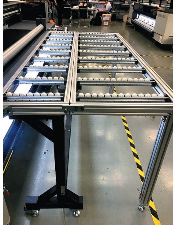
Приставные столы предназначены для удобной работы с листовыми материалами
