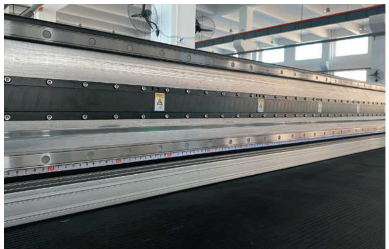
Перемещение каретки осуществляется при помощи магнитного линейного привода
