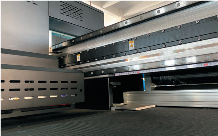
Рельсы обеспечивают отсутствие вибраций при работе каретки
