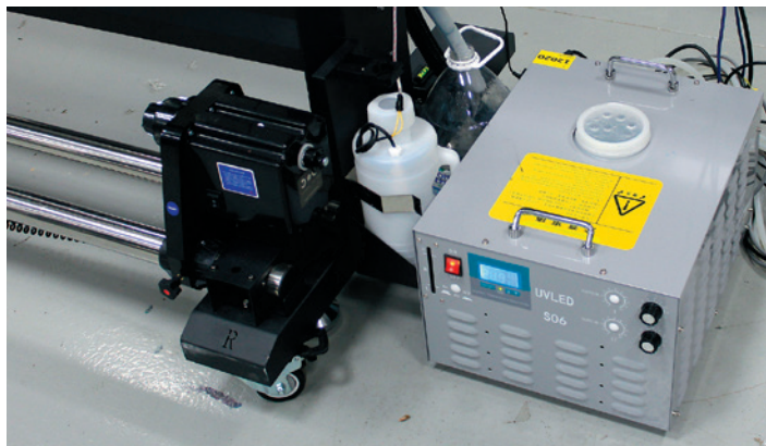
Для УФ-источников излучения в принтерах ARK-JET UV 1803 имеется бесшумная система водяного охлаждения с автоматической поддержкой заданной температуры. В качестве охлаждающей жидкости используется дистиллированная вода с небольшим количеством антифриза.
