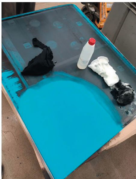
Результат воздействия регенератора OKTO Gummi Frisch Spezial на загрязнённое полотно
