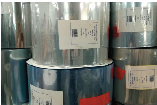
На входе каждый ролик маркируется штрихкодом с уникальным номером
