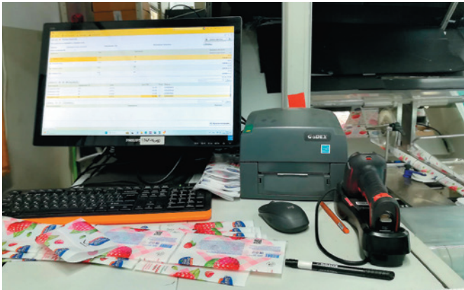
Оснащение рабочего места: компьютер, куда заносится вся информация о заказе, сканер штрих-кодов, принтер для печати этикеток с маркировкой для каждого ролика
