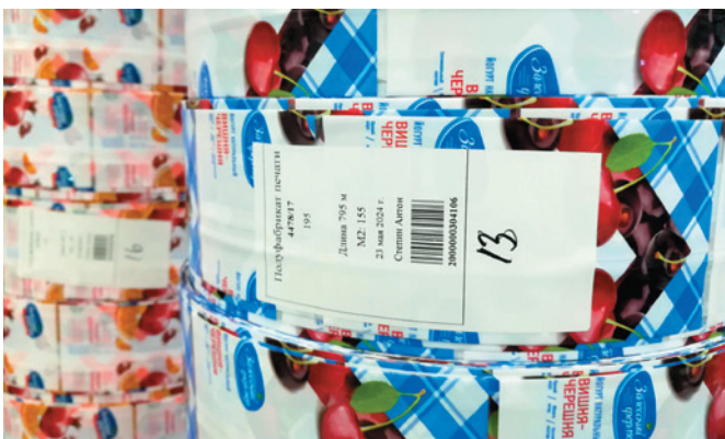
После печати ролику присваивается новый статус «Полу-фабрикат печати», и он снова маркируется
