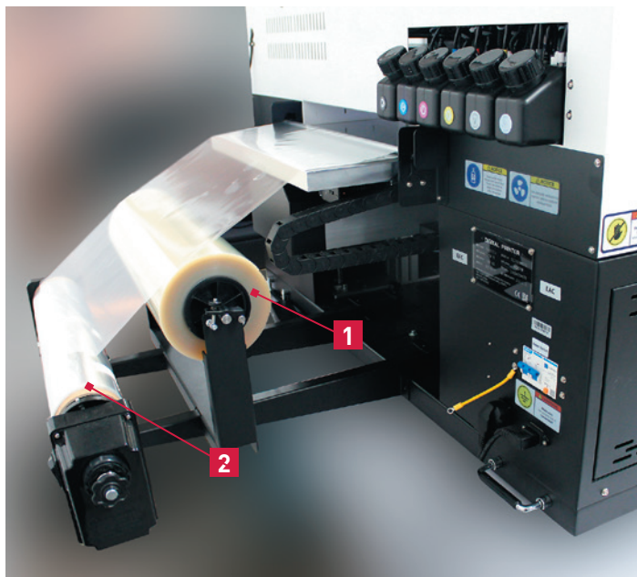
Подача плёнки А 1 на печать, намотка защитной плёнки 2
