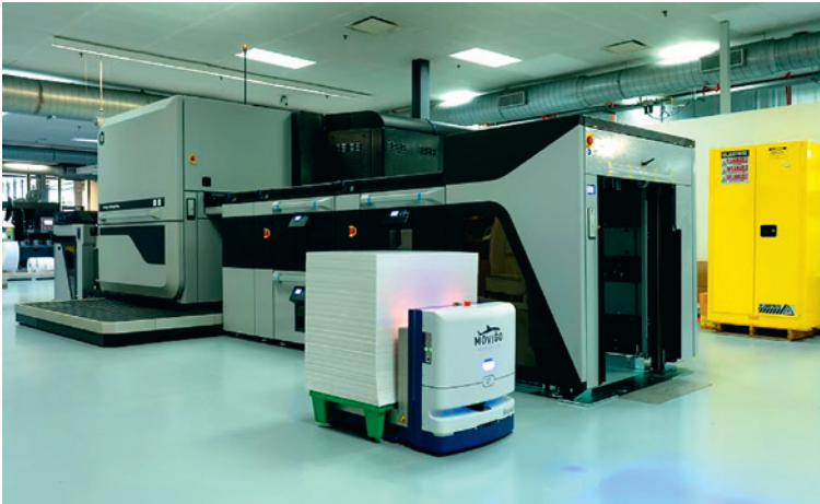
«Умный» робот MoviGo Robotics может перевозить расходные материалы и готовую продукцию по производству, позволяя операторам сосредоточиться на основной работе
