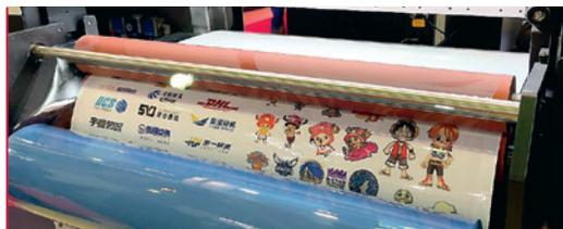
В UV DTF-принтер Oric A-600 Pro интегрировано устройство для горячего ламинирования плёнки непосредственно после печати, что сокращает ручные операции и обеспечивает на выходе плёнку с наклейками, полностью готовыми для переноса на изделия
