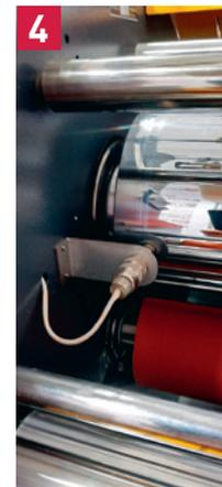
**2** Имеется автоматическое формирование нахлёста бумаги при помощи специального датчика и двух валиков.
