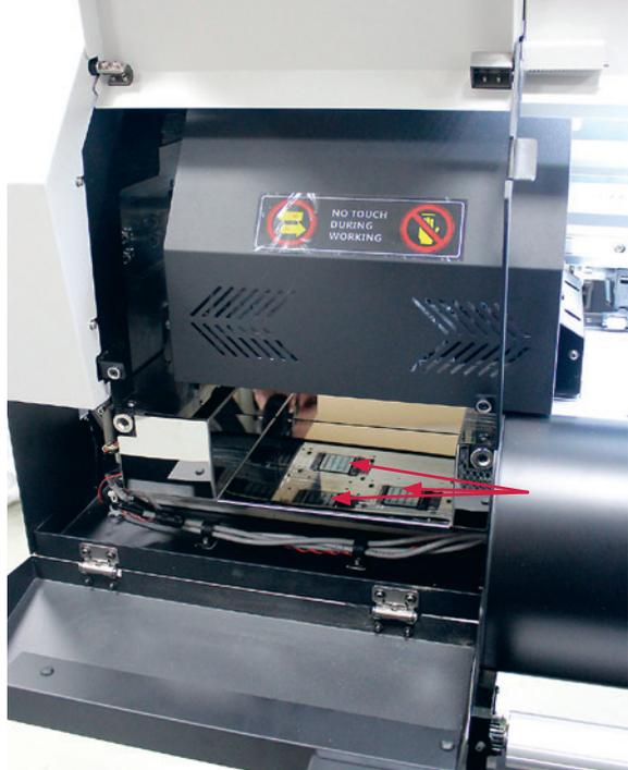
С левой стороны принтера есть рабочая зона для обслуживания оператором каретки и печатающих головок. Благодаря зеркальной поверхности оператор видит отражение каретки и сопел (отражение показано стрелками), что облегчает манипуляции при чистке
