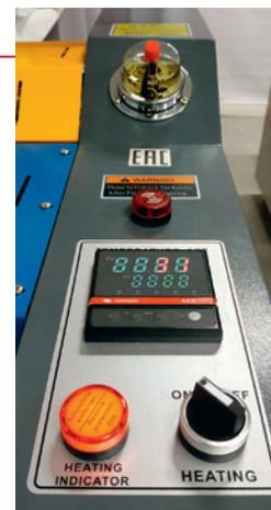
За постоянством давления в гидравлической системе можно следить при помощи отдельного манометра, который расположен рядом с панелью индикации температуры и включения нагрева
