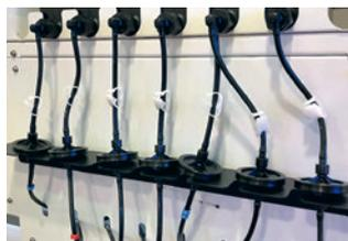
Автоматическая система подачи с циркуляцией белых чернил позволяет поддерживать каналы в рабочем состоянии, что снижает расходы на обслуживание и обеспечивает стабильную работу без простоев
