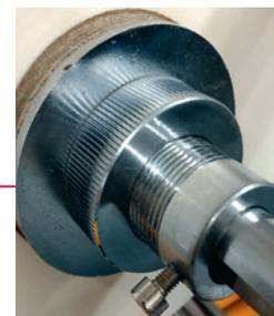
Натяжение плёнки регулируется соответствующим адаптером путём его зажима. Допускается использование только рулонов с плёнкой диаметром 77 мм
