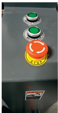
Кнопки аварийной остановки располагаются как на фронтальной стороне устройства, так и на задней панели управления вместе с кнопками ручного отрыва и пуска
