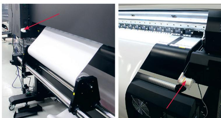
Системы намотки и размотки рассчитаны на втулки два и три дюйма. Размотка устроена просто, двигателей не имеет.
