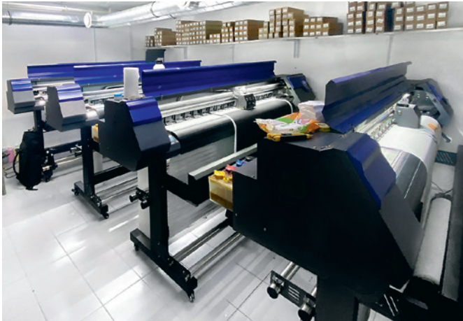
На производстве фотообоев Print Walls работает четыре экосольвентных принтера ARK-JET SOL 1600
