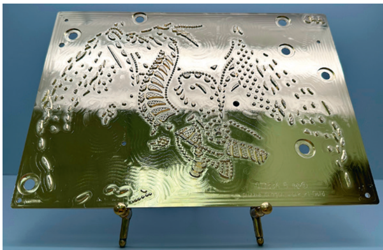
Комбинированное латунное клише для создания микрорельефов с фольгой и плоского тиснения
