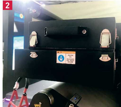
2 Устройство очистки бумажного полотна
