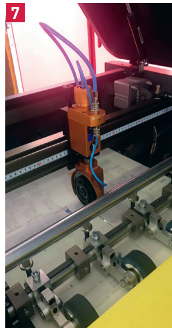
7 Дисковый нож для продольной резки бумажного полотна
