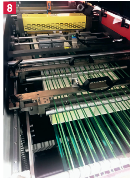
8 Под жёлтым кожухом находится ротационное устройство для поперечного реза. Может нарезать листы длиной от 190 до 590 мм
