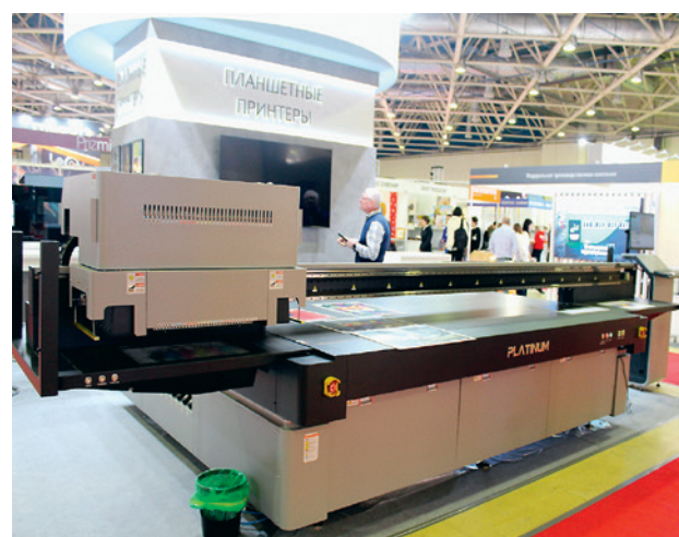
Некоторые экземпляры оборудования, показанного на выставке, имеют вполне промышленный масштаб. Показанный LIYU Russia широкоформатный гибридный УФ-принтер PLATINUM Q3XL китайского производителя LIYU International впечатлил размерами как каретки, так и экрана на пульте управления. Солидно выглядел и установленный рядом планшетный УФ-принтер PLATINUM KC 3020
