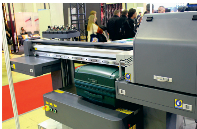
Некоторые модели планшетных УФ-принтеров способны запечатывать довольно большие предметы. Например, на стенде компании ULTRA S возможности сувенирного принтера демонстрировали, поместив в него чемодан
