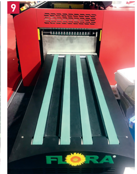
9 Транспортные ремни на выходе из модуля. Максимальная высота стопы на выкладе — 180 мм
