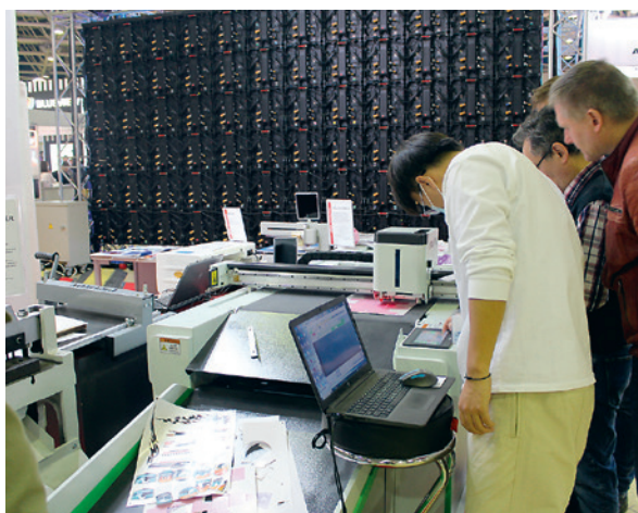
«НИССА Дистрибуция» показала в работе автоматический режущий плоттер AOL 1070 PAS 4 с возможностью установки различных инструментов
