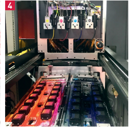
4 Блок из 13 печатающих головок для печати лицевой стороны, с парковочными местами. Каждая головка печатает сразу 2 цвета
