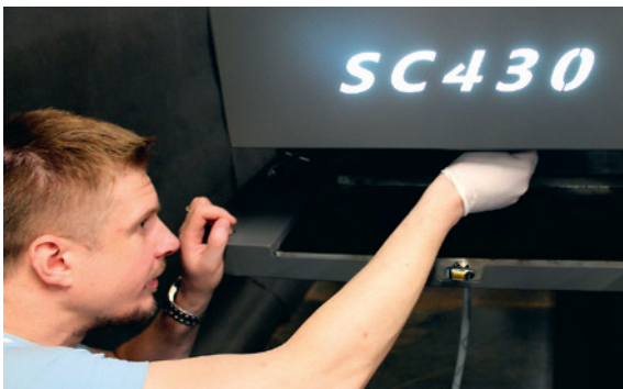
Протирка дюз производится вручную с помощью специальных салфеток из нетканого материала
