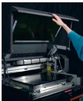
Большая передняя крышка с гидравлическими амортизаторами для лёгкости подъёма и защитным окном для зрительного контроля процесса печати.
