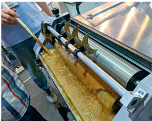
«Клеемазалка» **HATECO SMART PRO** предназначена для изготовления переплётных крышек средними и большими тиражами (подробнее см. *Захаржевский Ю.* HATECO SMART PRO // Publish № 10, 2022)
