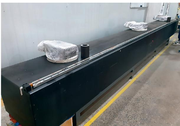
Прецизионный гранитный камень длиной более 3 м для проверки геометрии балок
