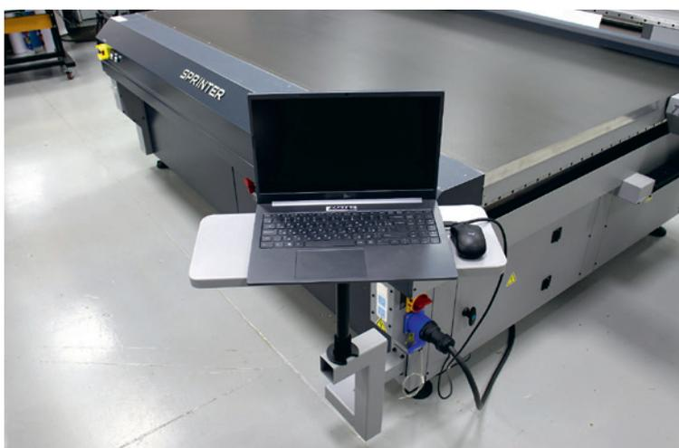
Компьютер для управления принтером устанавливается на специальной подставке. Передача данных к печатающей головке происходит по оптическому кабелю. Высокоскоростной интерфейс USB 3.0 помогает передаче больших массивов данных
