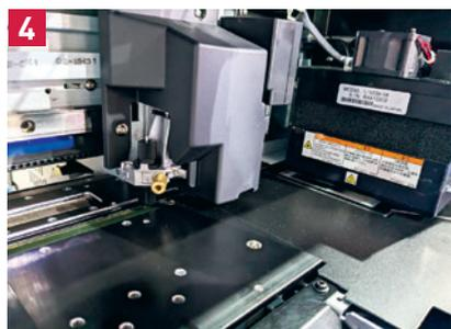
Режущее устройство с флюгерным ножом. 1 — две печатающие головки расположены в шахматном порядке; 2 — светодиодные УФ-сушки; 3 — каретка для режущего инструмента
