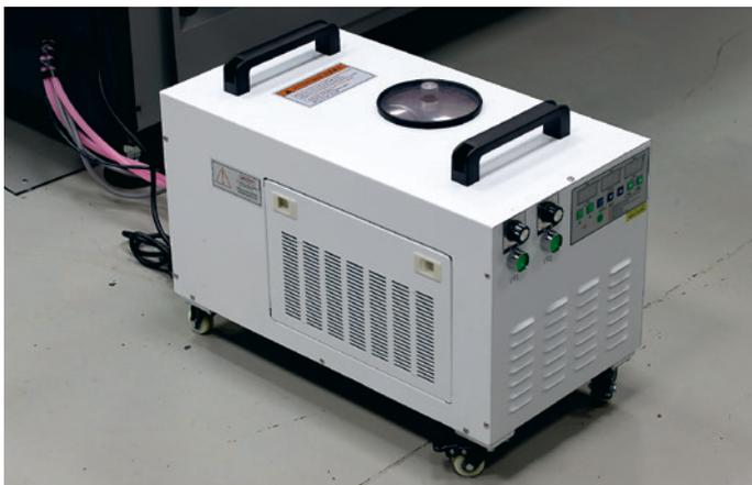
Высокая мощность светодиодных ламп — до 1500 Вт — требует эффективного охлаждения. На фото — система водяного охлаждения и управления светодиодными лампами, помогающая легко подобрать нужную мощность излучения. Система бесшумна и проста в обслуживании
