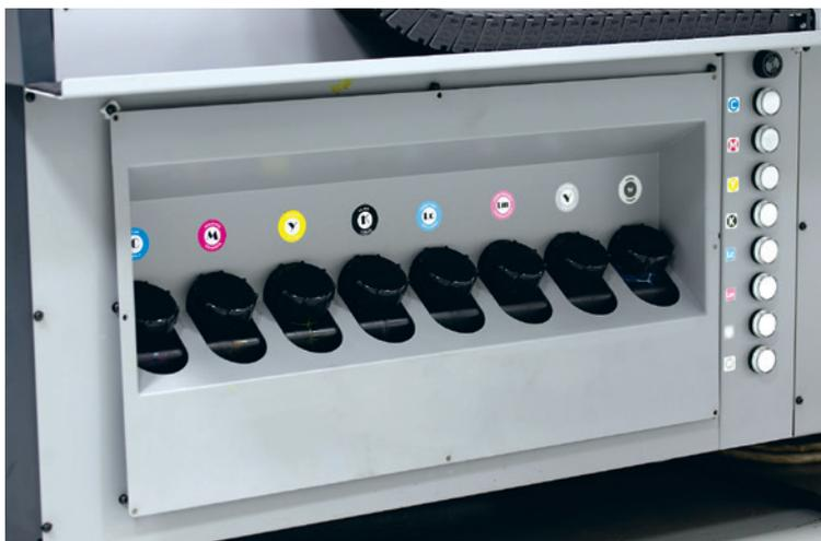
СНПЧ с большими чернильными ёмкостями, каждая из которых оснащена звуковой сигнализацией, срабатывающей при достижении минимального уровня чернил. Одновременно срабатывает световая сигнализация (вертикальный ряд ламп справа).
