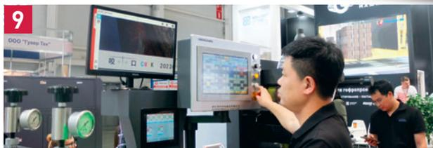
Управление машиной осуществляется с помощью сенсорного пульта. В дополнение к нему каждая печатная секция оснащена небольшими панелями управления.
