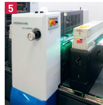
Опциональная полуротационная флексографская УФ-лакировальная секция с камерной системой для сплошного или выборочного лакирования
