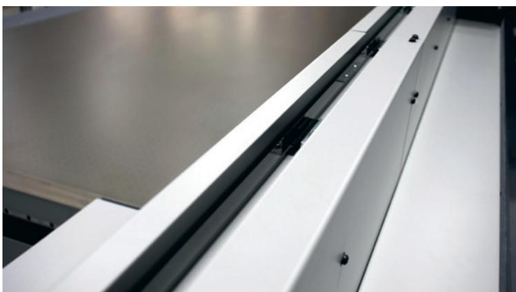
Для контроля движения каретки используется оптический энкодер высокого разрешения, что необходимо для качественной печати с высоким разрешением. На фото — лента энкодера для контроля перемещений по оси X
