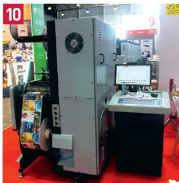
Запечатываемое полотно сматывается в рулон диаметром до **750 мм**.
