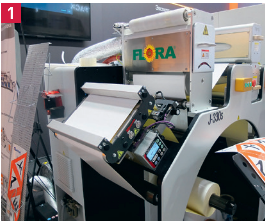
1 Модуль выравнивания и натяжения полотна от BST и стол для его склейки
