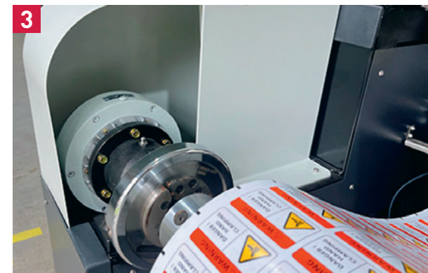
3 Интеллектуальная система контроля натяжения с ультразвуковыми датчиками, которые определяют место расположения полотна обрабатываемого материала
