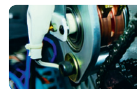
Датчик температуры, встроенный в вал
