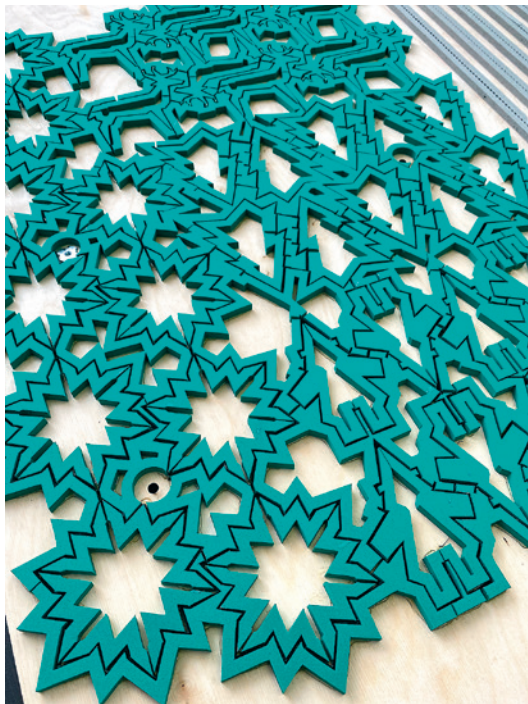
Штанцформа под автоматический тигельный пресс для высечки сложных криволинейных контуров
