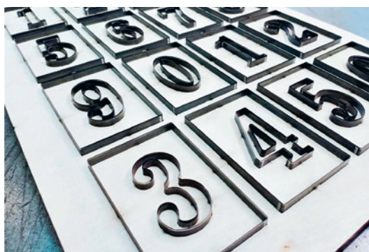
Штанцформа для высечки изделий из пенополиэтилена
