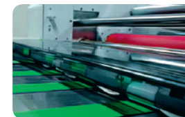
Механизм автоматической протяжки листов со шторкой для автоматического нахлёста
