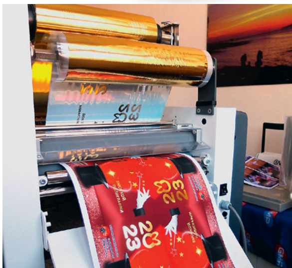
Выборочное фольгирование и работа ревайндера
