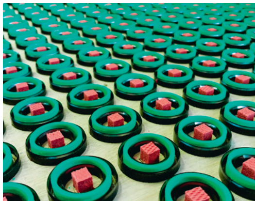
Проклейка, подобранная на основании работы тестовой штамповки под нестандартный материал (полиуретан + резина)
