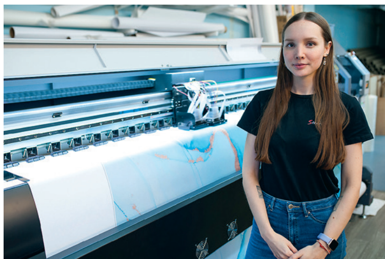
Принтер ARK-JET SOL 3202 с шириной рабочего поля 3,2 м отлично справляется с печатью бесшовных обоев
