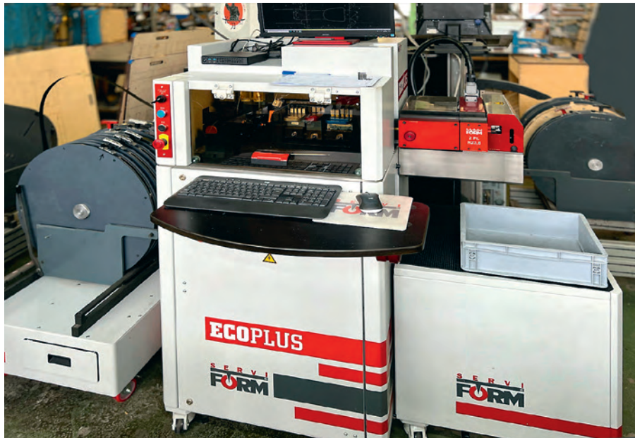
Станок для обработки ножей EcoPlus работает в автоматическом режиме: ручные операции минимизированы
