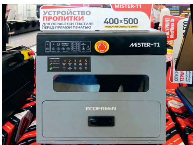
Для прямой печати служит показанное на стенде компании «Смарт-Т» устройство пропитки ECOFREEN MISTER T-1 , которое наносит праймер на текстильные материалы перед прямой печатью. При солидных тиражах такое устройство позволяет ускорить работу и понизить зависимость в рабочей силе
