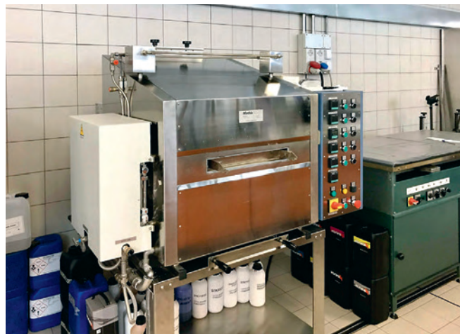
Фото 5. Лабораторный зрельник для проверки реактивных чернил
