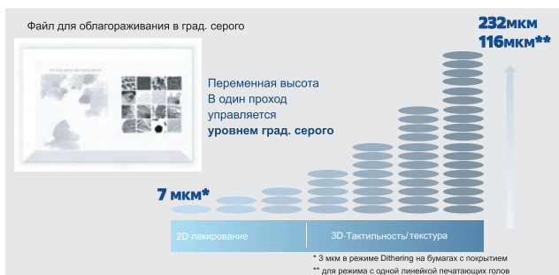
Рис. 2. Управление высотой УФ-лака (Konica Minolta JETvarnish 3D)
