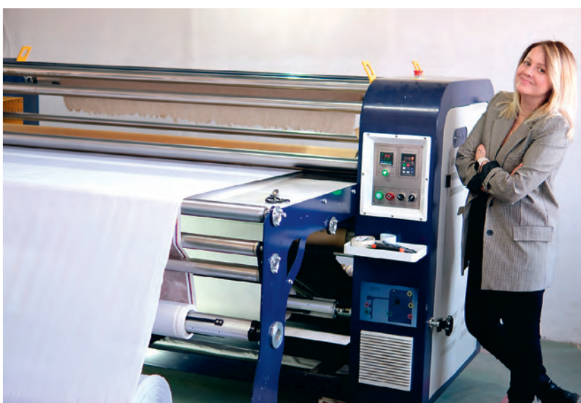
NOTA 1700 Plus: каландр играет важнейшую роль в качественном переносе изображения с бумаги на ткань
