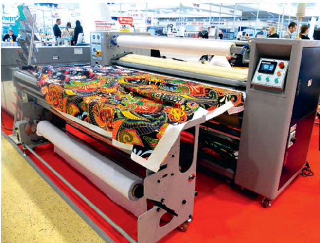
На стенде «Смарт-Т» был показан термокаландр TitanJet RTX34-1800 для сублимационного переноса и термофиксации (фото слева), а на стенде компании «Ковчег» — термокаландр НОТА 220-1700 PLUS
