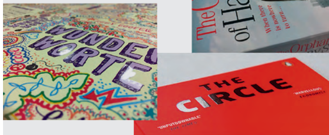
Рис. 5. Выборочное лакирование: высота слоя до 30 мкм, высота лака одинаковая на всех элементах
