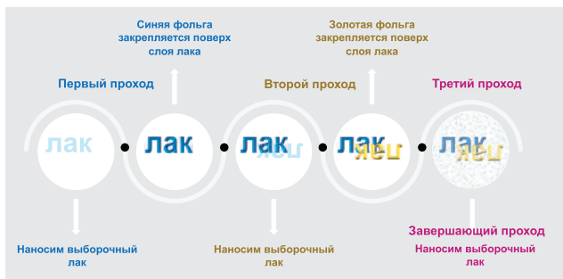
Рис. 3. Варианты цифровой отделки лаком и фольгой, принципы работы
