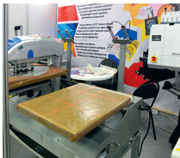
Автоматический термопресс TPE 4050 с двумя столами на стенде компании TechnoPrint. Лазерная подсветка помогает правильно располагать термотрансферную бумагу на обрабатываемом материале или изделии. Цена такого термопресса — 280 тыс. руб.
