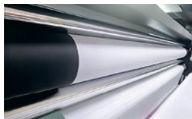
Резиновый вал для равномерной подачи материала без замятий и складок
