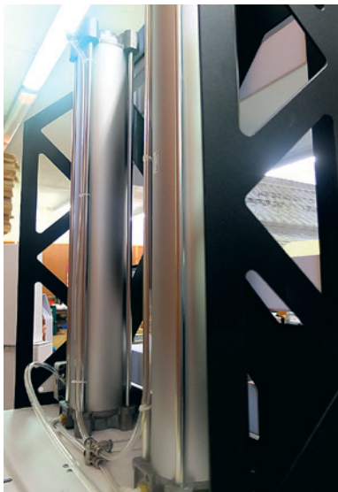
Пневматические цилиндры, через которые осуществляется давление
