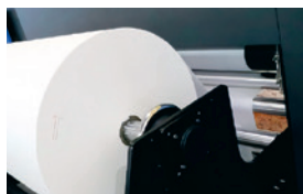
Резиновый вал для равномерной подачи материала без замятий и складок
