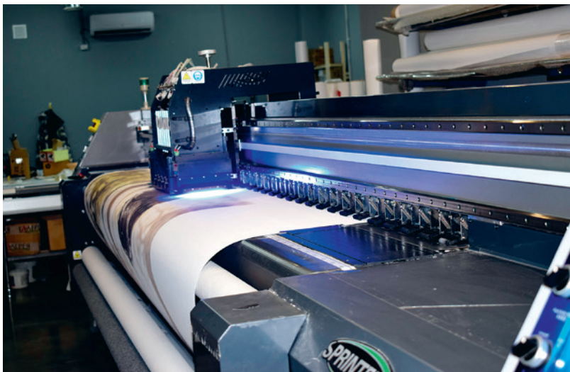
ARK-JET UV RTR 3200 — широкоформатный рулонный УФ-принтер с рабочим полем 3,2 м для печати на любых, даже самых деликатных материалах
