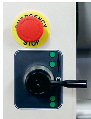
Ручка управления давлением ламинирования
