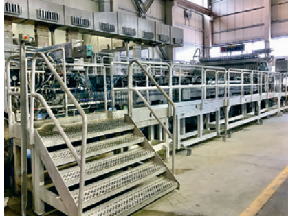
Рис. 22.1. Стол с сетчатым транспортёром
