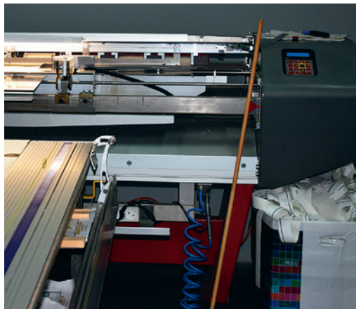
Искусно исполненный и настроенный вручную итальянцами рулонный резак Fotoba XLD 170 WP
