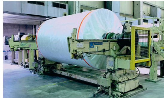
Рис. 30.1. Подача рулона для покрытия полимерным слоем
