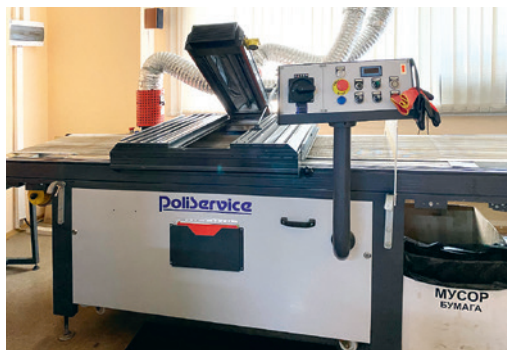
Автоматический высекальный пресс AEM-800 позволяет получать картонные коробки необходимой формы
