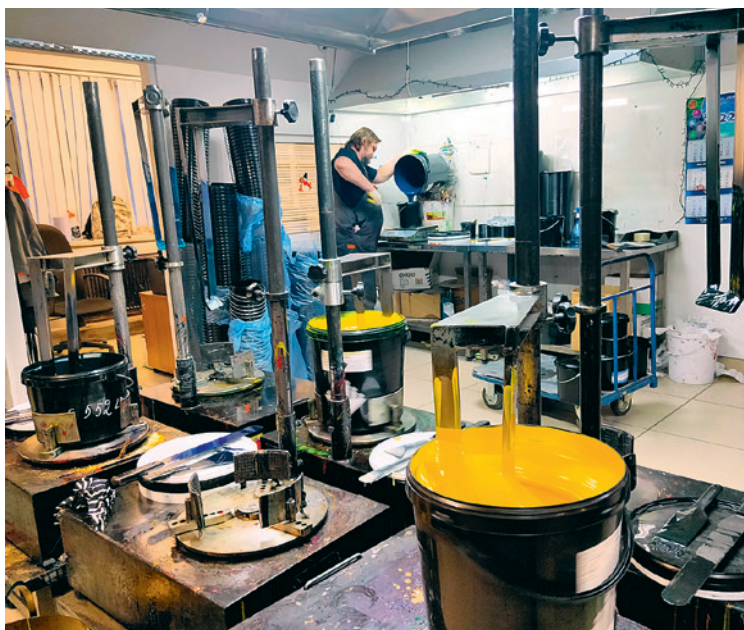
Краску заданного цвета и характеристик изготавливают на нескольких станциях смешения
