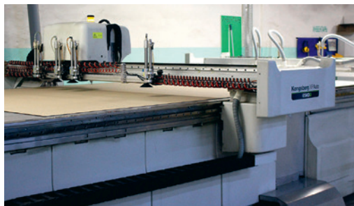
Рис. 5. Планшетный принтер HP Scitex 11000 и режущий плоттер Esko Kongsberg XP Auto на производстве Svetofor (Тверь)
