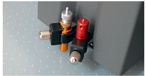
Рабочий узел плоттеров серии F может нести два инструмента. На фото инструмент для биговки находится справа, флюгерный нож — слева
